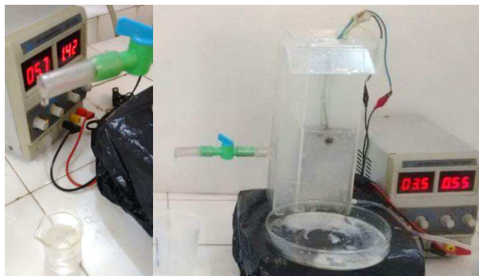
Figura 5.2. Reator eletroquímico operando no tratamento da emulsão sintética.
