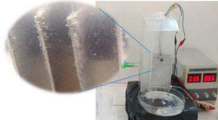
Figura 5.3. Formação das bolhas de gás na superfície dos eletrodos.
