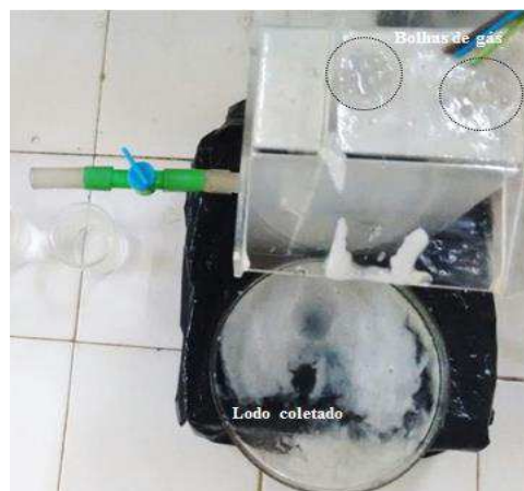
Figura 5.4. Vista superior do reator com a formação de lodo e bolhas superficiais.
