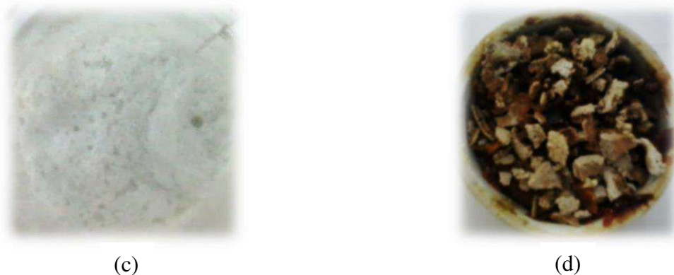
Figura 5.6. Lodo obtido da emulsão sintética imediatamente após o experimento (c) e, após a secagem (d).
