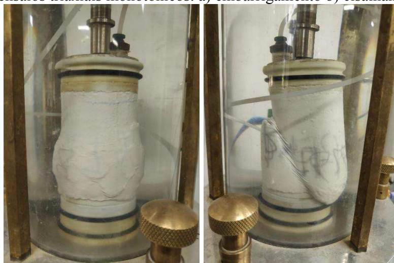
Figura 127 - Diferentes modos de ruptura apresentados pelas amostras de areia estabilizada em ensaios triaxiais monotônicos. a) embarrigamento b) cisalhamento
