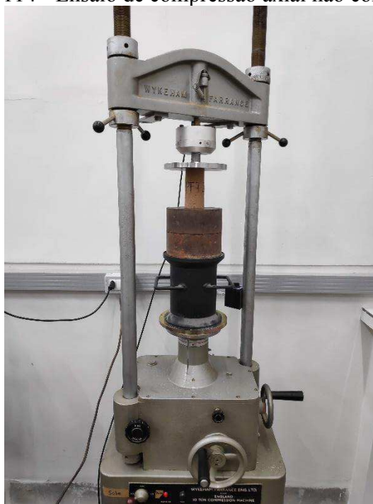
Figura 114 - Ensaio de compressão axial não confinada.
