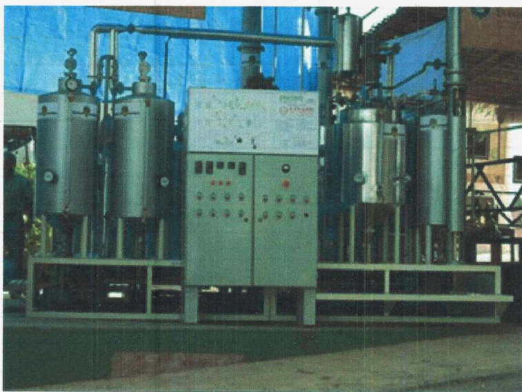
Figura 42: Unidade Piloto industrial de produção de biodiesel para diversos óleos vegetais do fabricante Linard Engenharia e Fundição de Missão Velha-CE. Foto de Vicente de Paula Queiroga.
