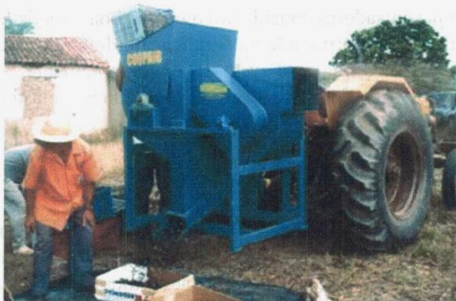
Figura 4: Máquina descascadora de frutos de mamona com acionamento por trator. Foto de Odilon Reny Ribeiro Ferreira da Silva.
