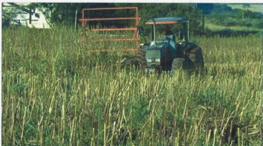
Figura 9: Colheitadeira semi mecanizada de gergelim para atender as pequenas áreas de produção de agricultores familiares. Foto de Túlio Benatti.
