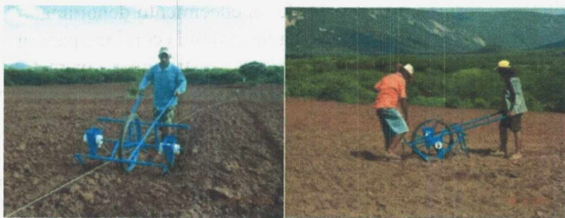
Figura 4: Semeadora mecânica manual de duas linhas para plantio de sementes de gergelim. Municípios de Lucrécia-RN, ano 2010. Fotos de Ana Yimiko Kojima.
