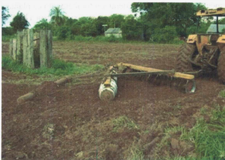
Figura 2: Gradagem e nivelamento do solo ao mesmo tempo com o arrasto de um toco roliço amarrado à grade (cultivo mínimo). Foto de Odilon Reny Ribeiro Ferreira da Silva.
