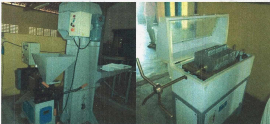
Figura 25: Prensa de extração de óleo e pequeno filtro de prensa de gergelim da Cooperativa Agroindustrial dos Produtores Familiares de Lucrécia-RN (COAFAL). Fotos de Rogério Fernando Martinelli.
