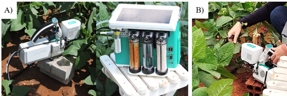
Figura 2 - Mensuração das trocas gasosas em plantas de feijoeiro com o Analisador de gases por infravermelho (A e B).
