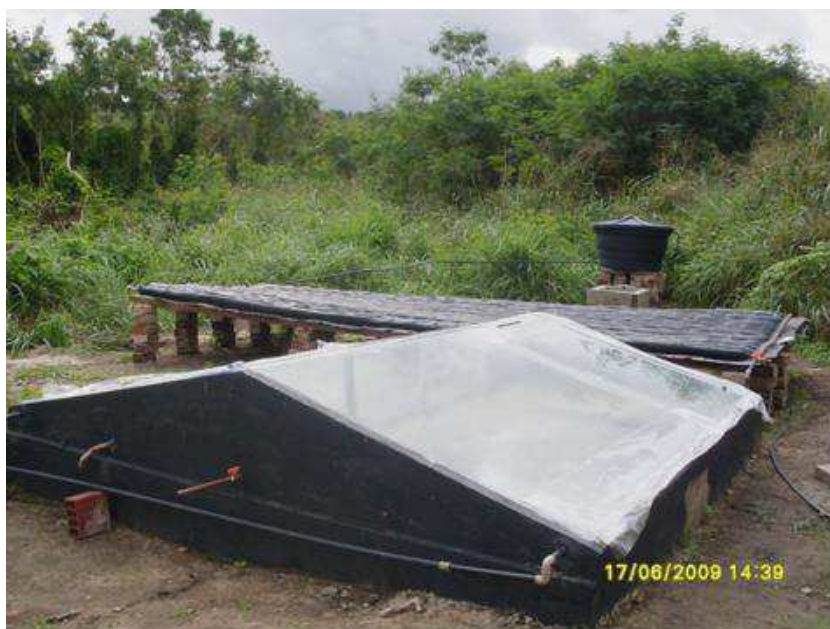
Figura 6. Caixa de alvenaria para evaporação/condensação da água.
