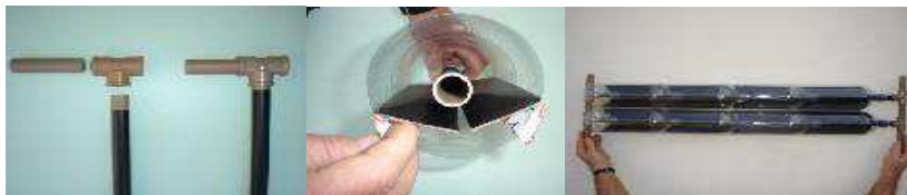
Figura 4: Montagem da tubulação. A) Tubos de PVC pintados em preto. B) Garrafas PET e caixas Tetra Pak. C) Disposição do sistema de tubos.
