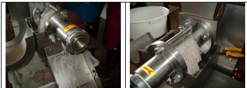
Figura 6. Equipamentos para obtenção de Carne Mecanicamente Separada. Fonte: Valnir de Meneses Campos - Laboratório de Piscicultura DZ/CCA/UFPB.
