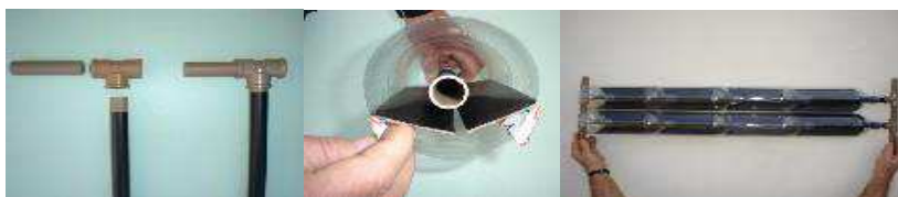
Figura 2: Montagem da tubulação. A) Tubos de PVC pintados em preto. B) Garrafas PET e caixas Tetra Pak. C) Disposição do sistema de tubos.
