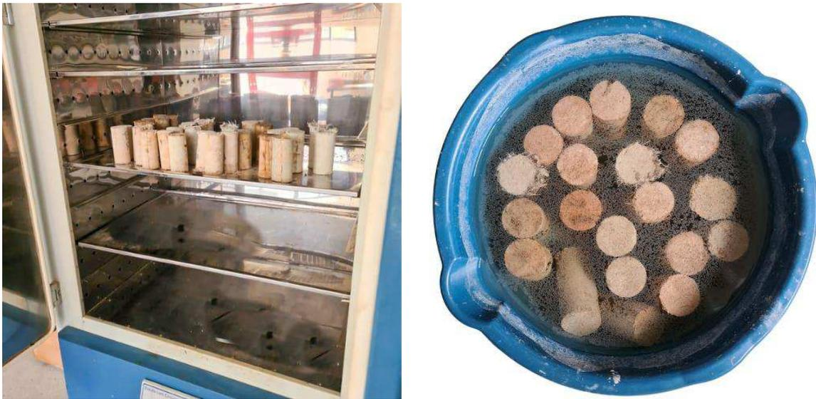
**Figura 11.** Ensaio de absorção de água por imersão
