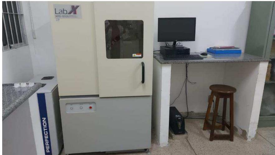
**Figura 16.** Difratorômetro de Raios X (DRX) Shimadzu XRD-6000
