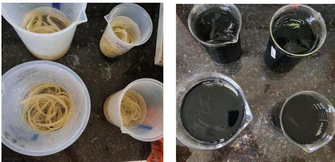
**Figura 4.** Teste de absorção de água em fibras vegetais.
