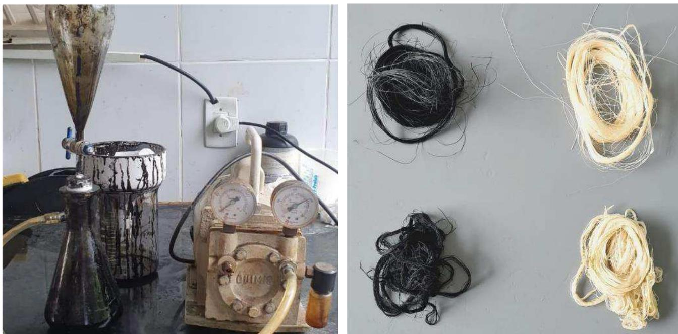
**Figura 10.** Sistema de destilação do licor pirolenhoso e fibras vegetais com e sem tratamento
