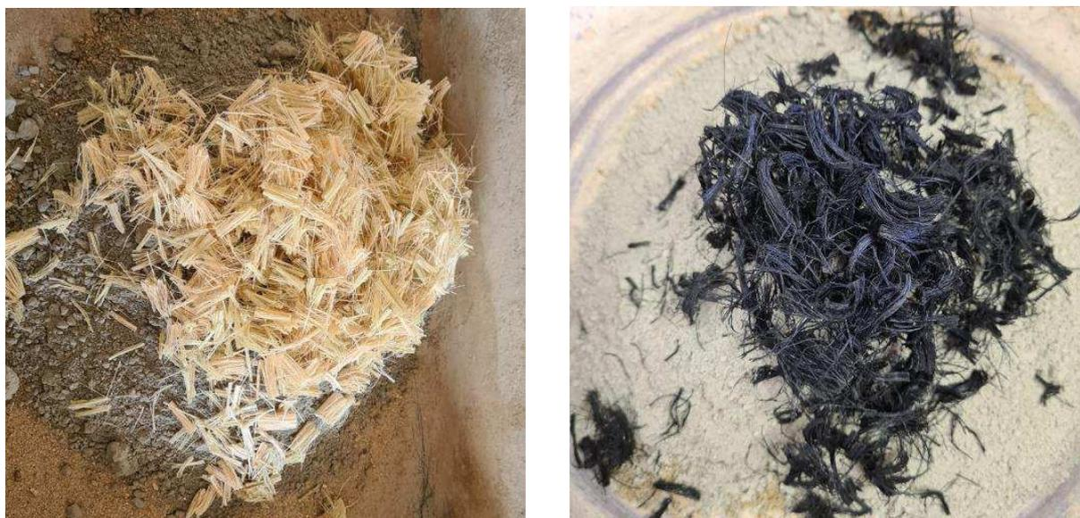
**Figura 3.** Mistura dos materiais utilizados para confecção da matriz de fibrocimento.
