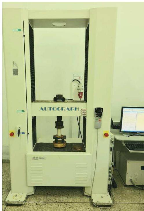
**Figura 13.** Ensaio de compressão uniaxial na máquina Shimadzu AG - IS
