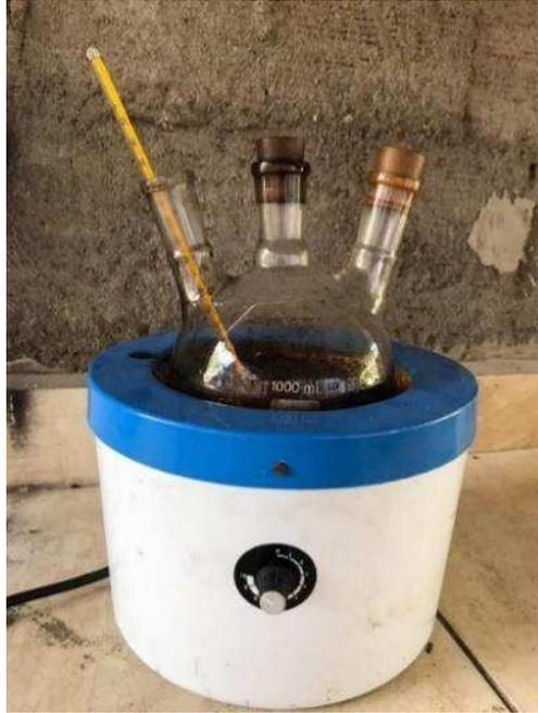
**Figura 8.** Destilação do licor pirolenhoso em manta térmica.
