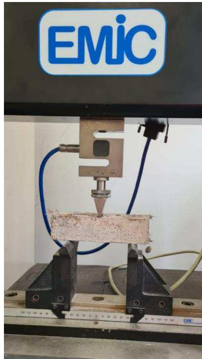
**Figura 12.** Ensaio de flexão em três pontos.
