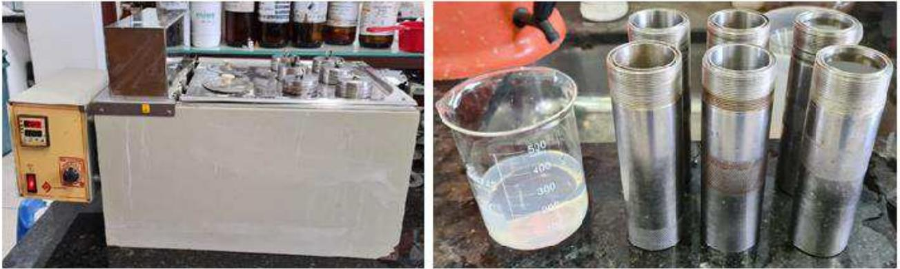
**Figura 7 .**Tratamento de fibra por hidrólise organossolve
