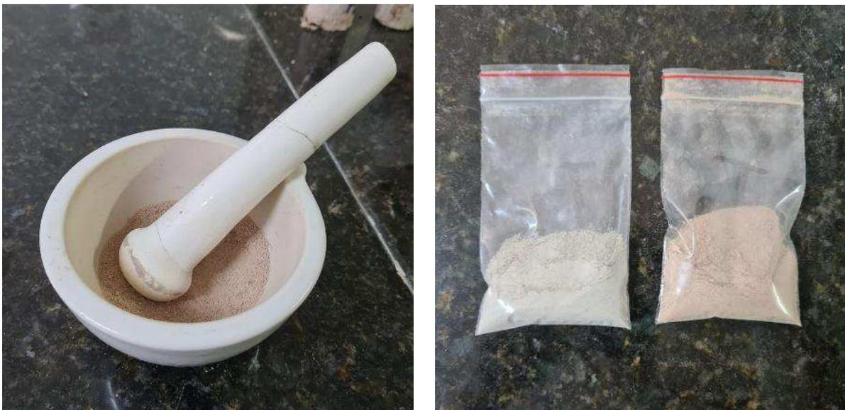
**Figura 17.** Preparação das amostras para a análise no DRX
