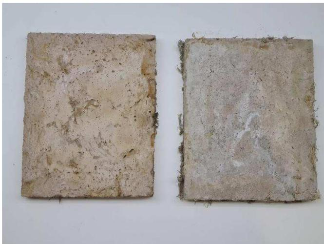
**Figura 18.** Placa utilizada para o ensaio de condutividade térmica.
