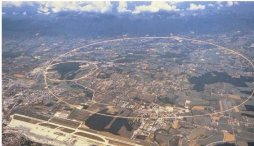
Figura 28: Foto de vista aérea da região em Genebra (Suíça) onde se encontra o CERN, laboratório onde foi descoberto o bóson de Higgs. O anel maior com cerca de 7,5 km de diâmetro representa o Grande Colisor de Hádrons, e o menor, o Super Síncrotron de Prótons, com aproximadamente 2 km de diâmetro, ambos localizados no subsolo.
