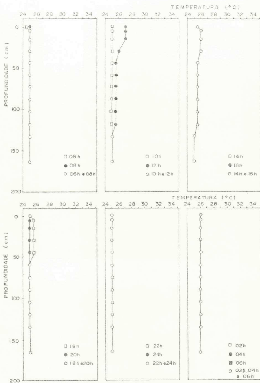
Figura 4.3 - Variações diárias de temperatura na coluna d'água da lagoa facultativa F9 (22-23/01/86).
