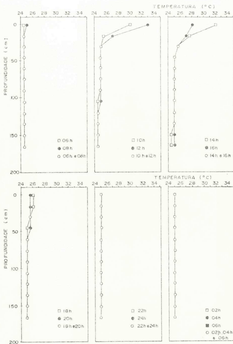
Figura 4.2 - Variações diárias de temperatura na coluna d'água da lagoa facultativa F9 (16-17/12/85).
