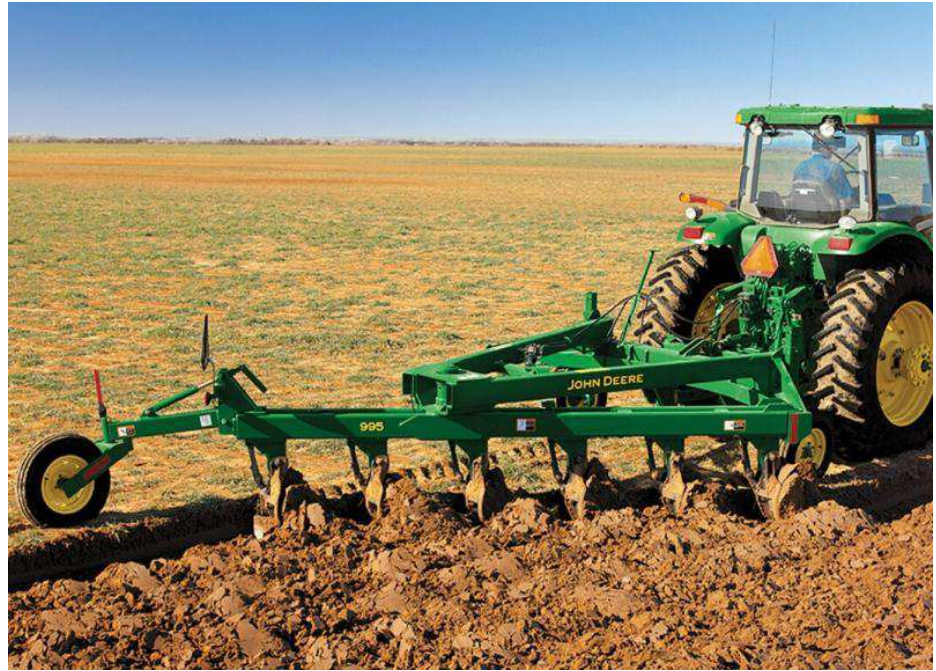
Figura 4: Arado de aiveca acoplado a um trator. (Fonte: John Deere).
