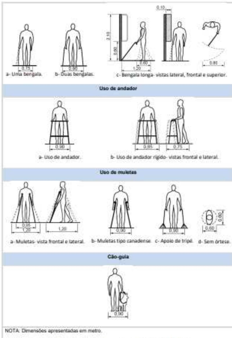
Figura 3 - Quadros sobre a acessibilidade da norma NBR9050/ABNT.
