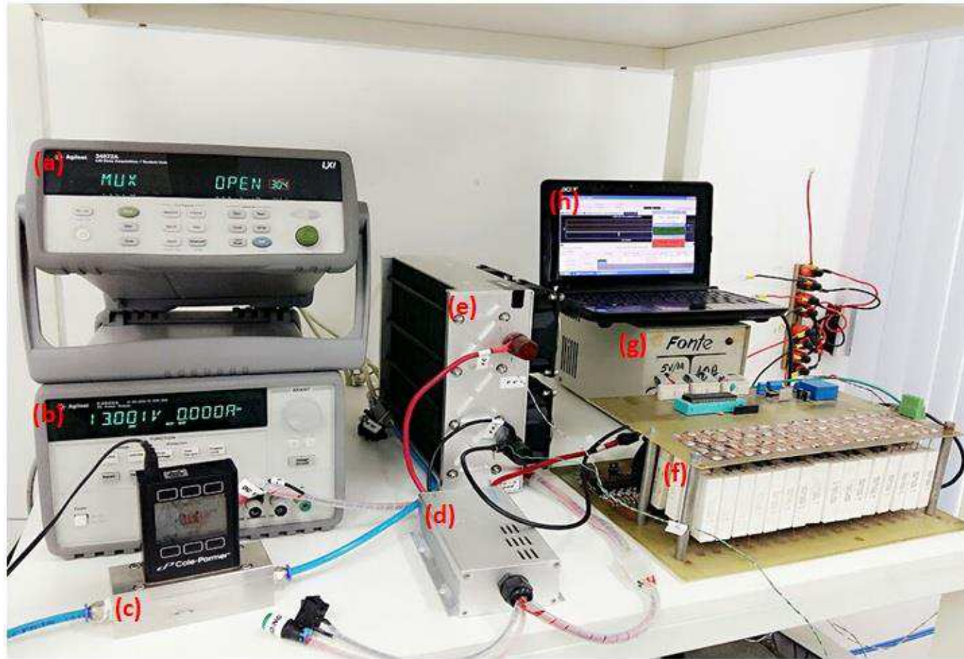
Figura 29: Bancada de trabalho (a) Multímetro Dígita; (b) Fonte de alimentação de 13 V; (c) Fluxômetro; (d) Controlador da célula a combustível; (e) Célula a Combustível; (f) Carga resistiva; (g) Fonte de 12 V e; (h) Notebook para a captação dos dados.
