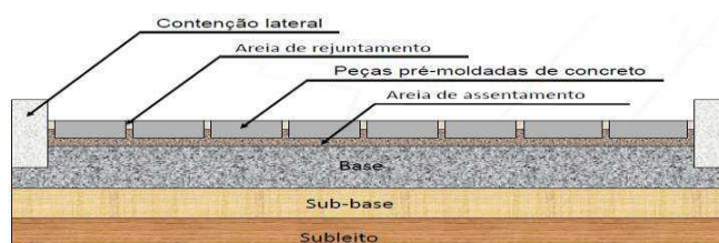
Figura 4 - Seção transversal pavimento intertravado.
