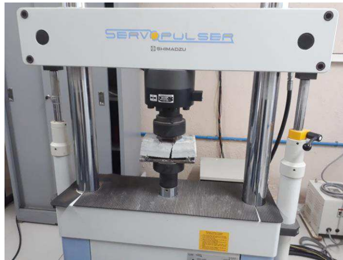
Figura 20 - Ensaio de resistência à tração na flexão.
