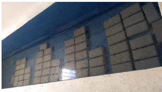
Figura 15 - Peças em cura submersa.
