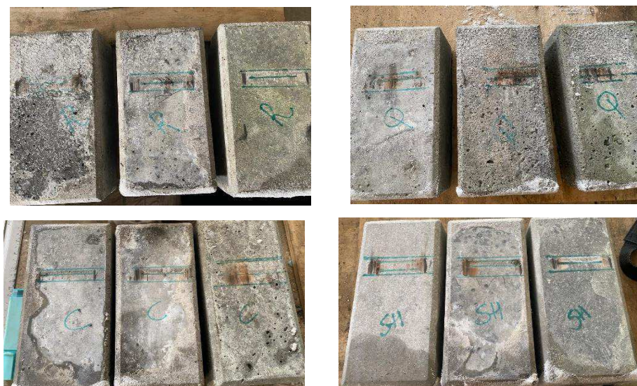
Figura 46 - Leituras do ensaio e as devidas marcações para cada paver .
