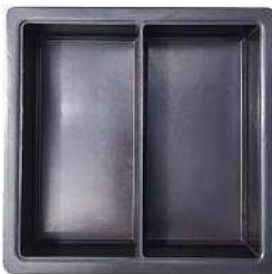
Figura 12 - Fôrmas retangulares em PVC utilizada nas moldagens.
