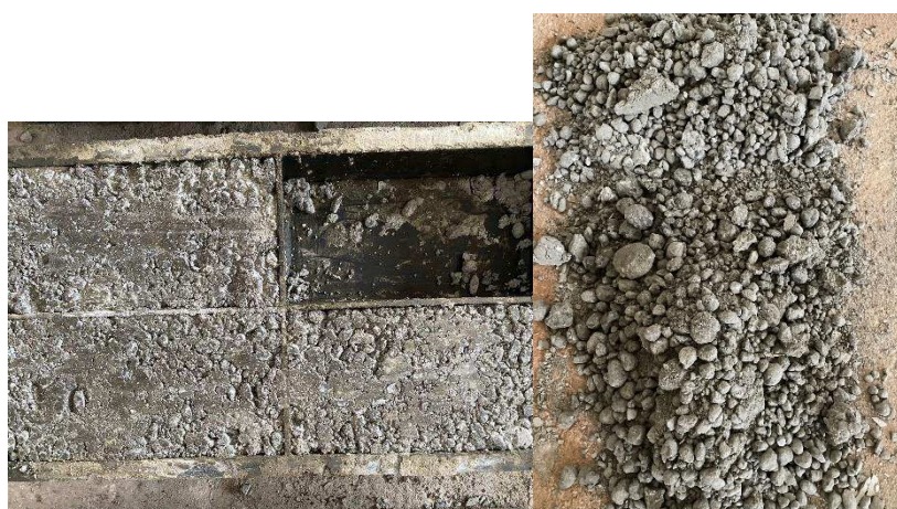
Figura 37 - Moldagem do concreto com utilização do ROL.
