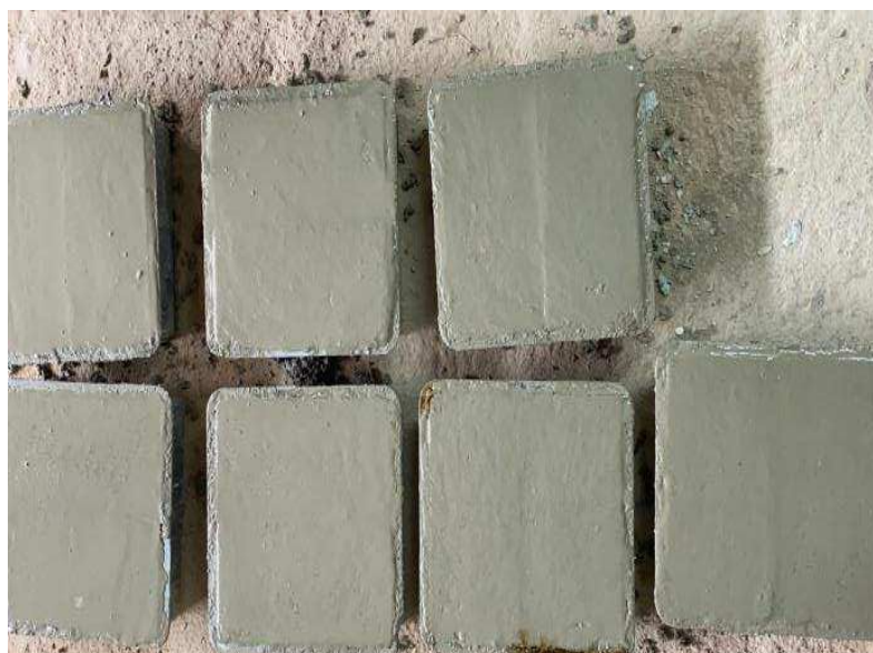
Figura 13 - Peças com acabamento da face superior.
