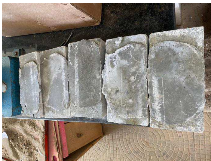
Figura 14 - Peças após capeamento.
