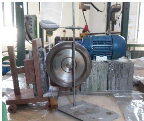
Figura 22 - Ensaio de desgaste por abrasão
