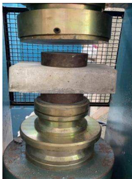
Figura 16 - Ensaio de resistência à compressão.
