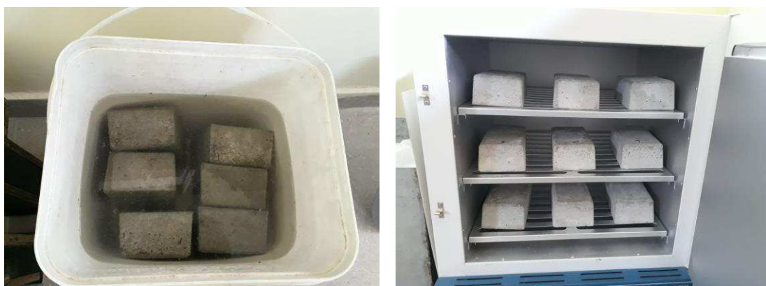
Figura 17 - Determinação da absorção de água dos pavers .
