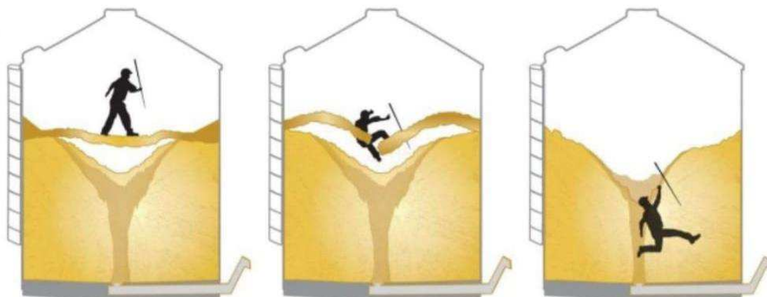
Figura 1 - Soterramento em silo de armazenamento de grãos.
