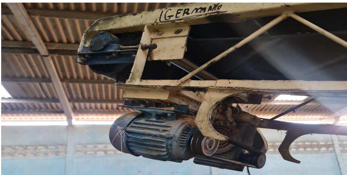
Figura 21 - Partes móveis do motor da esteira exposta.
