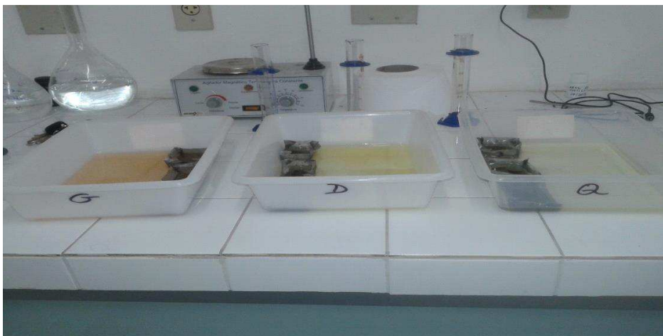
Figura 08 – Teste de adsorção da gasolina, diesel e querosene sob a Vorg.
