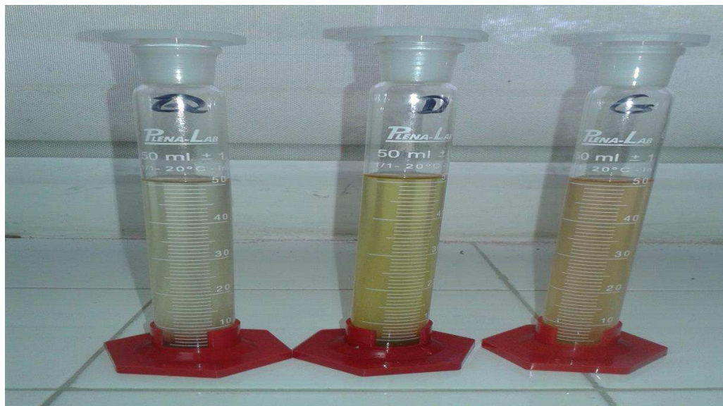
FIGURA 9 - Ilustração do teste de inchamento de Foster, utilizando gasolina, querosenes e diesel sob a Vorg.
