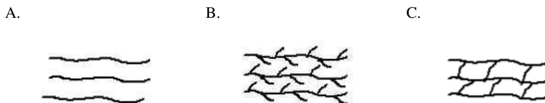
Figura 1. Representação das cadeias dos polímeros: linear sem ramificação (a); linear com ramificação (b); tridimensional com ligações cruzadas (c).
