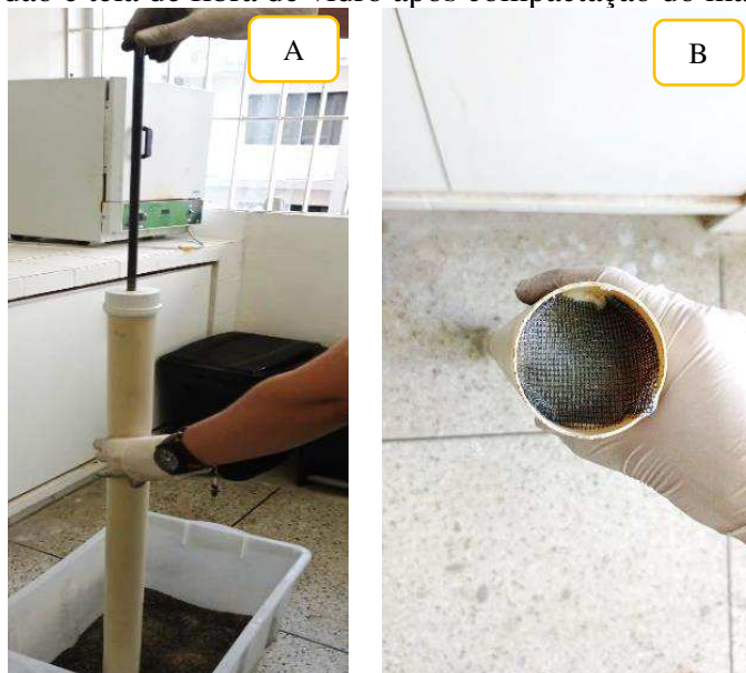
Figura 30 – Colunas de adsorção: A) Compactação do material adsorvente; B) Inserção da camada de algodão e tela de fibra de vidro após compactação do material adsorvente
