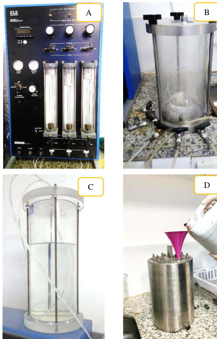
Figura 21 – Componentes do Tri-Flex 2 utilizados no ensaio de permeabilidade vertical: A) Painel de controle; B) Câmara de permeabilidade; C) Reservatório de água destilada; D) Reservatório de lixiviado
