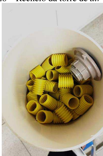
Figura 26 – Recheio da torre de air stripping
