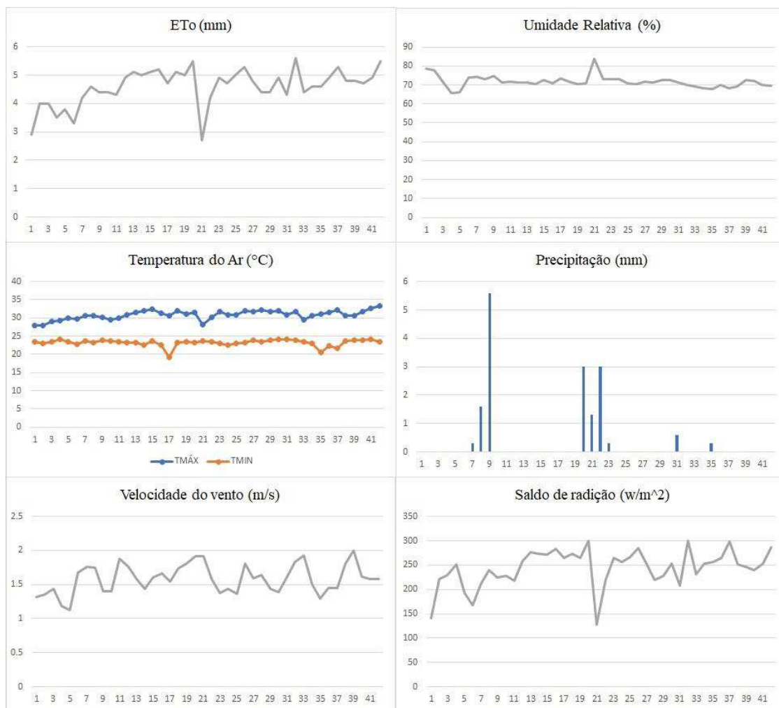
Figura 9. Dados meteorológicos da estação meteorológica automática Irriplus E5000 da Unidade Acadêmica de Ciências Atmosféricas da Universidade Federal de Campina Grande: a) Evapotranspiração de referência, b) Temperatura do ar, c) Umidade relativa do ar, d) Radiação, e) Precipitação e f) Velocidade do vento.
