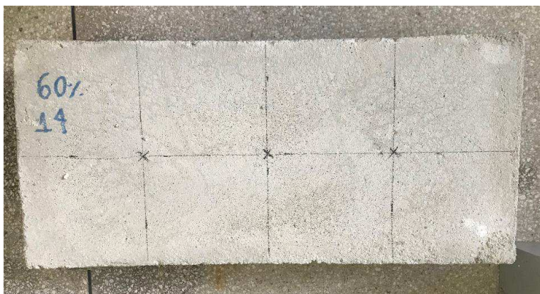
Figura 22 - Identificação da localização para instalar sensores na placa de argamassa
