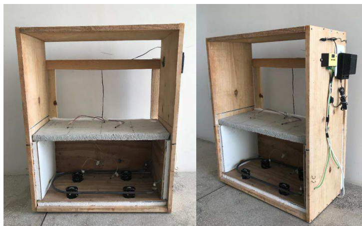
Figura 25 - Vista frontal e perspectiva do protótipo com placa de argamassa
