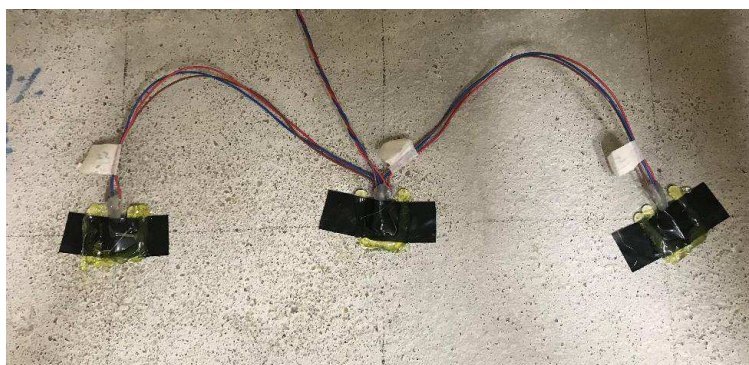
Figura 23 - Fixação dos sensores na placa de argamassa
