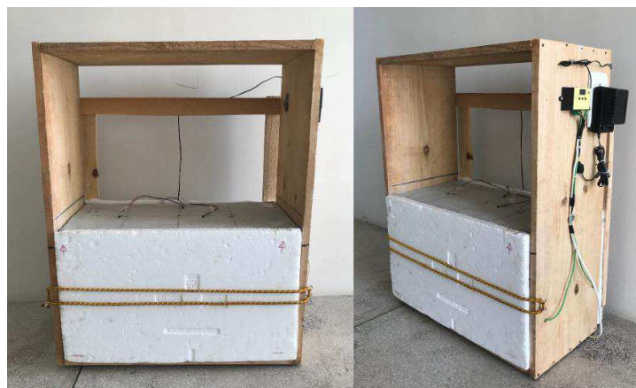
Figura 26 - Vista frontal e perspectiva do protótipo com placa de argamassa e fechamento isopor
