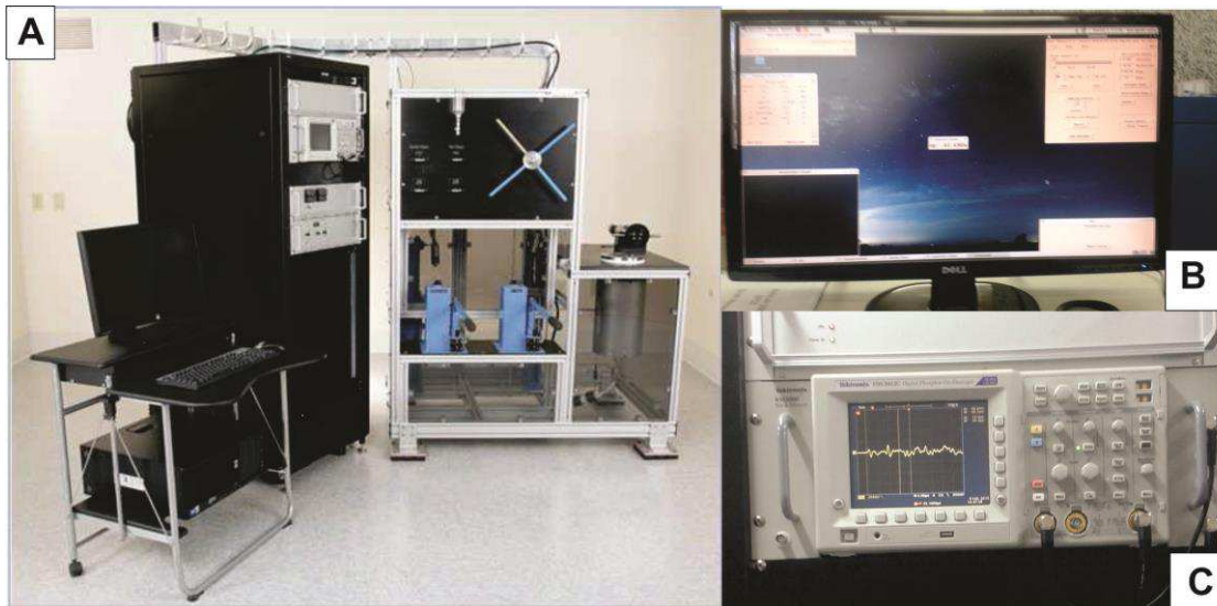
Figura 5.13: (A) Equipamento utilizado para medição de propriedades elásticas, (B) tela de visualização dos dados e (C) Osciloscópio que registra os sinais das ondas P, S_1 e S_2 .
