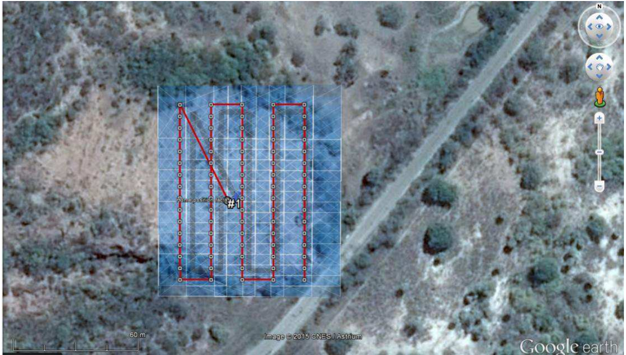
Figura 5.7: Rota de aquisição de imagens aéreas feitas pelo drone
