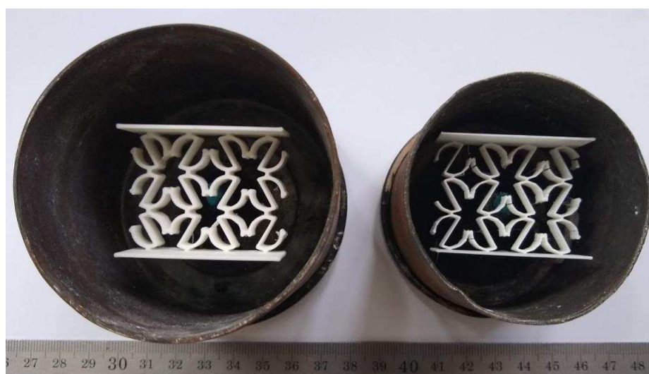
Figura 31 – Árvore do modelo 3D junto com o anel metálico.
