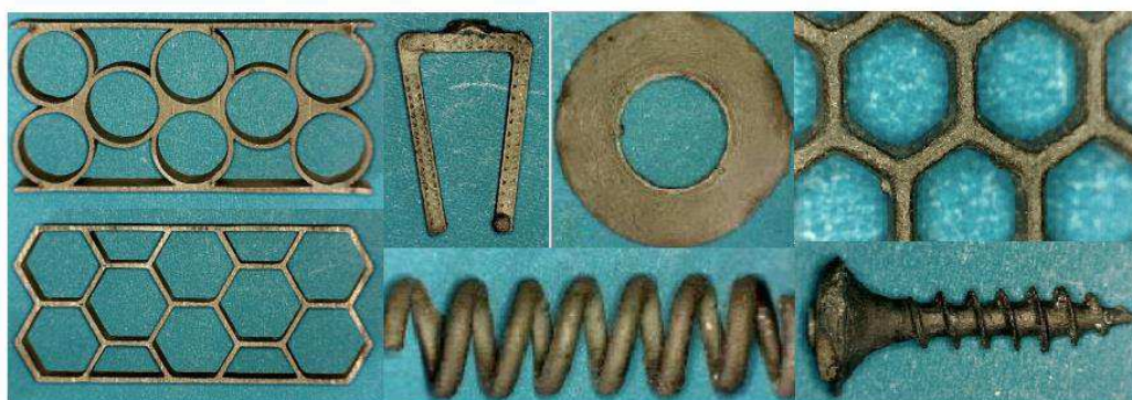
Figura 12 – Componentes mecânicos obtidos por fundição de precisão com cera perdida.
