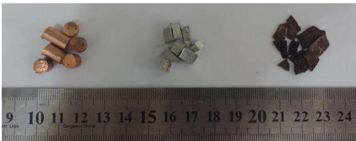
Figura 28 – Matéria prima (Cu, Al e Mn) para fundição das estruturas celulares.
