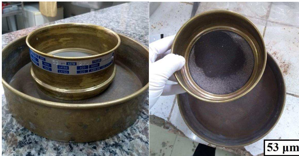
Figura 41. Peneira empregada e tamanho do grão em função da peneira utilizada.
