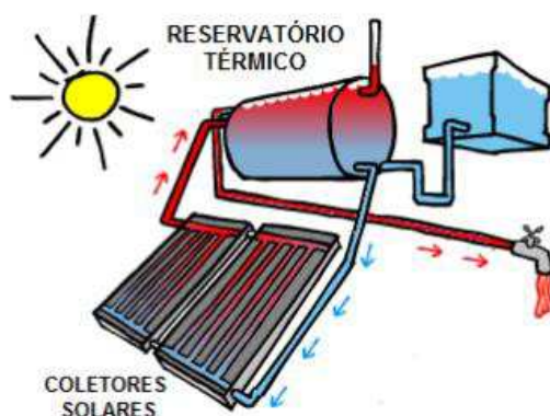
Figura 1. Esquema de operação de um sistema de aquecimento de água para uso doméstico.
