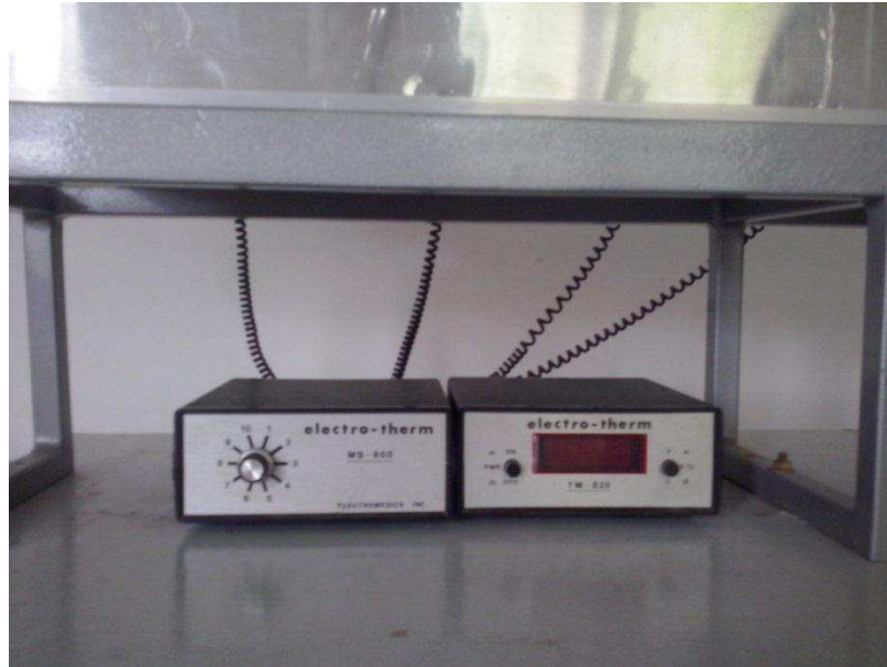
Figura 3. 7 - Aparelho para medição da temperatura Electro –Term MS-800
