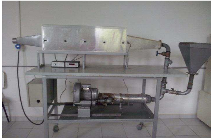
Figura 3. 5 - Secador de leito fixo para secagem em camada espessa.
