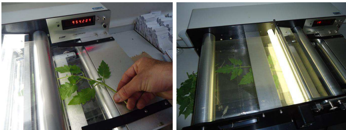
Figura 5. Medição da área foliar em tomateiro tipo cereja, utilizando-se um medidor de áreas de bancada, modelo LI-COR - LI-3100C. Campina Grande/PB, 2013.
