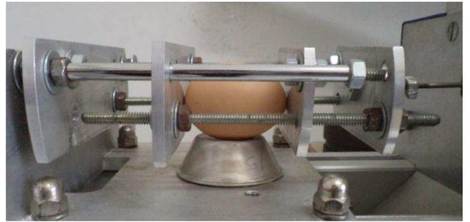
Figura 14. Máquina de cisalhamento modificada para teste de compressão dos ovos
