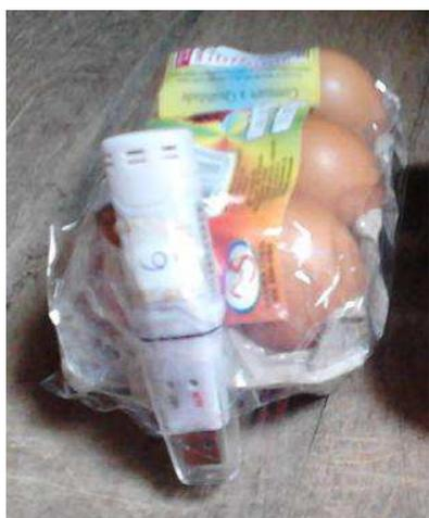
Figura 7. Sensor HT-500 instalado na bandeja de ovos
