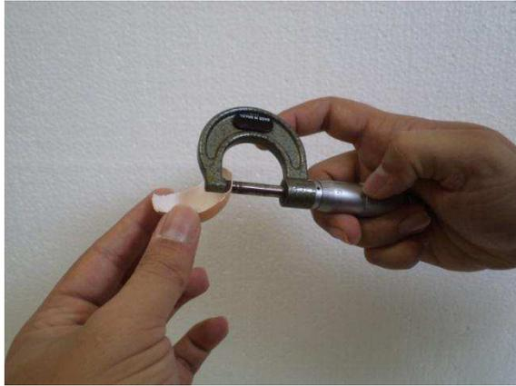
Figura 13 – Medição da espessura da casca
