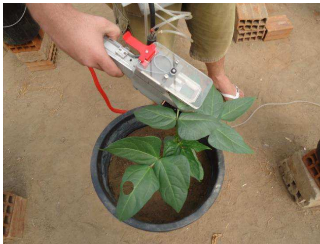
Figura 2: Avaliação da concentração interna de CO 2 ( C_i ), condutância estomática ( g_s ), transpiração ( E ) e fotossíntese líquida ( A ) utilizando o analisador de gás infravermelho IRGA.
