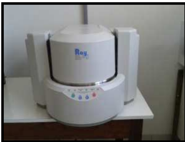
Figura 3.8- Espectrômetro de dispersão de raios X, modelo EDX-720
