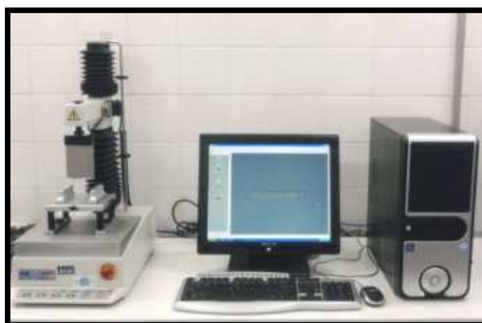
Figura 3.9- Equipamento utilizado para determinação dos atributos de textura, TAXTplus – STABLE MICRO SYSTEMS
