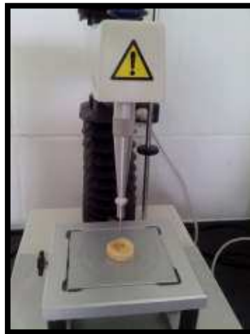
Figura 3.10- Ensaio de ruptura de fibras utilizando-se o Probe P/2
