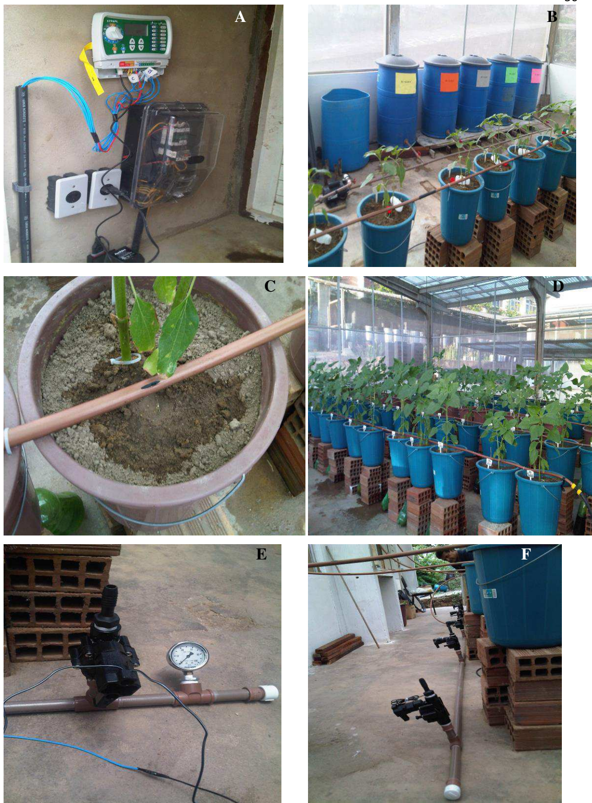
Figura 08. Quadro de controle e energia do sistema de irrigação (A) Vista dos reservatórios utilizados no experimento (B) Formação do bulbo no vaso (C) Linhas de Gotejadores (D) Manômetro para controle de pressão dentro da unidade de irrigação (E) Válvulas elétricas de acionamento da linha lateral (F).
