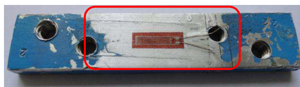
Figura 40 – Procedimento de colagem do extensômetro
