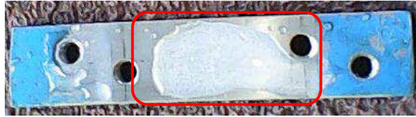
Figura 39 - Limpeza da superfície para aplicação do extensômetro
