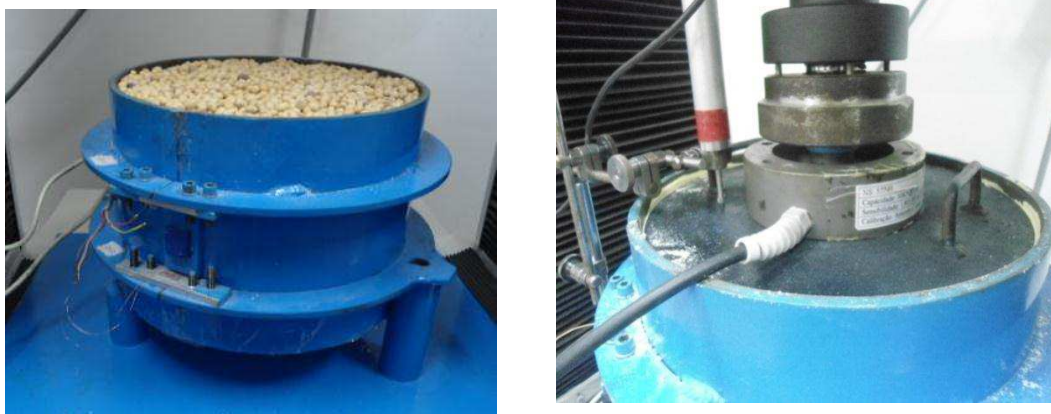
Figura 48 - a) Produto nivelado. b) Ensaio de compressão em andamento
