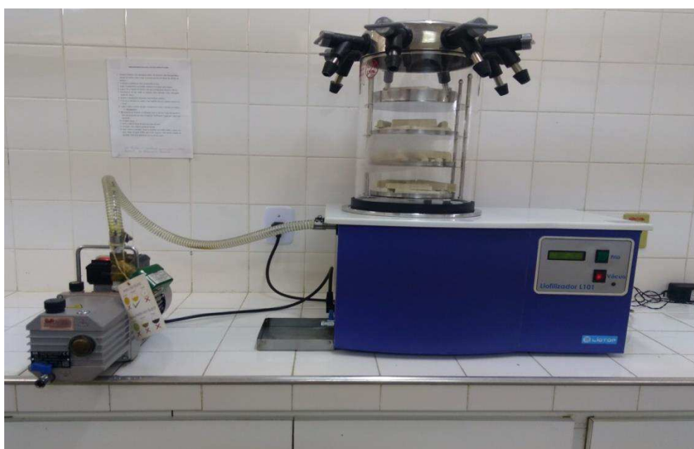
Figura 4.1. Liofilizador de bancada modelo L101.
