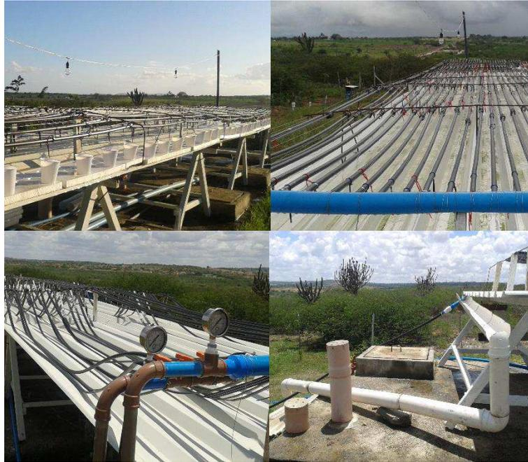
**Figura 14 - Vistas gerais da bancada de ensaios de tubos gotejadores.**
