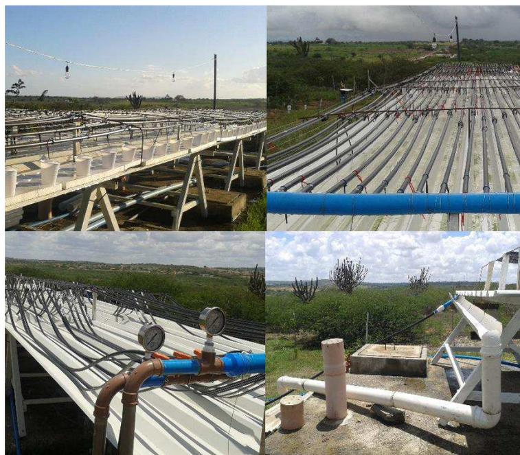
**Figura 7 - Vistas gerais da implantação da bancada de ensaios de tubos gotejadores.**
