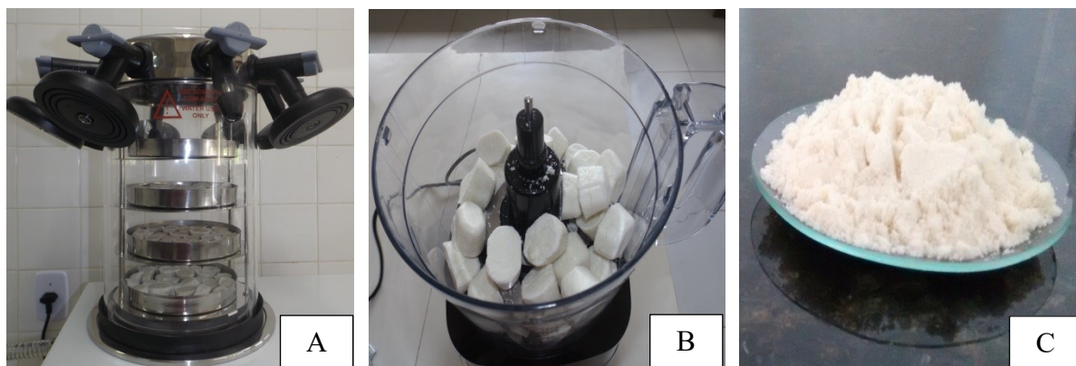
Figura II.1. Extratos formulados submetidos à liofilização (A); desintegração das amostras em multiprocessador (B); extrato em pó de amendoim (C). (Fonte: AUTOR, 2016).
