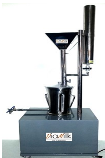
Figura I.1. Equipamento utilizado para obtenção do extrato aquoso de amendoim. (Fonte: BARROS NETO et al., 2014).
