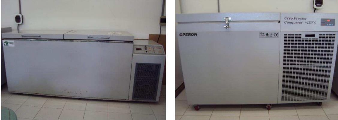
**Figura 3.1** – Balcões semi-criogênico e criogênico a  $-80$  e  $-150\text{ }^{\circ}\text{C}$ , respectivamente
