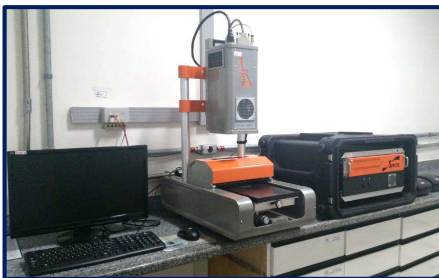
Figura 10. Espectrômetro sisuChema SWIR - Specim®, responsável pela obtenção das imagens hiperespectrais
