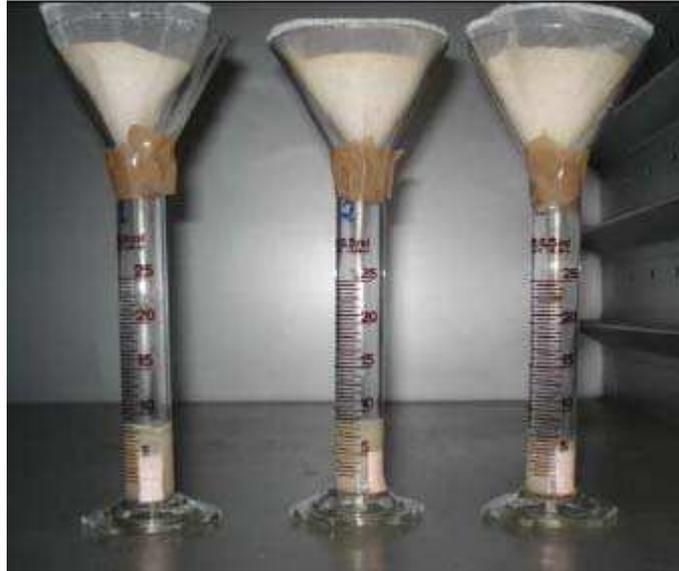
**Figura 3.3** – Sistema de medição da estabilidade da suspensão
