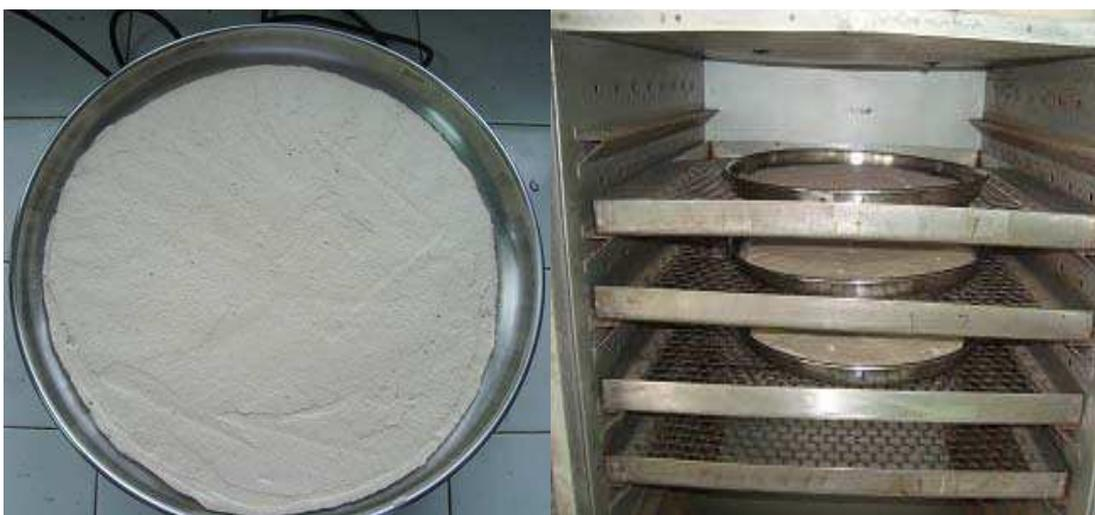
**Figura 3.4** – Processo de obtenção da camada de espuma com posterior secagem em estufa com circulação de ar
