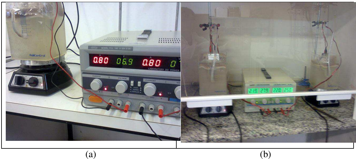
Figura 3.1 – Arranjo experimental do sistema de batelada. (a) fonte de eletricidade; (b) Vasos com eletrofloculação.
