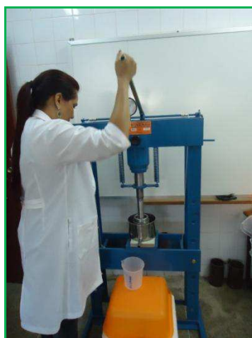
Figura 10. Prensa hidráulica do tipo P 30 ST, 30 TON BOVENAU
