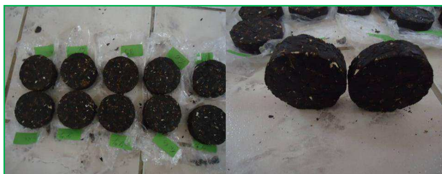
Figura 11. Torta do pinhão-mansó prensada 20 toneladas
