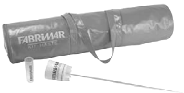
Figura 9 - Kit de ensaio de precipitação Fonte: FABRIMAR IRRIGAÇÃO (2012)
