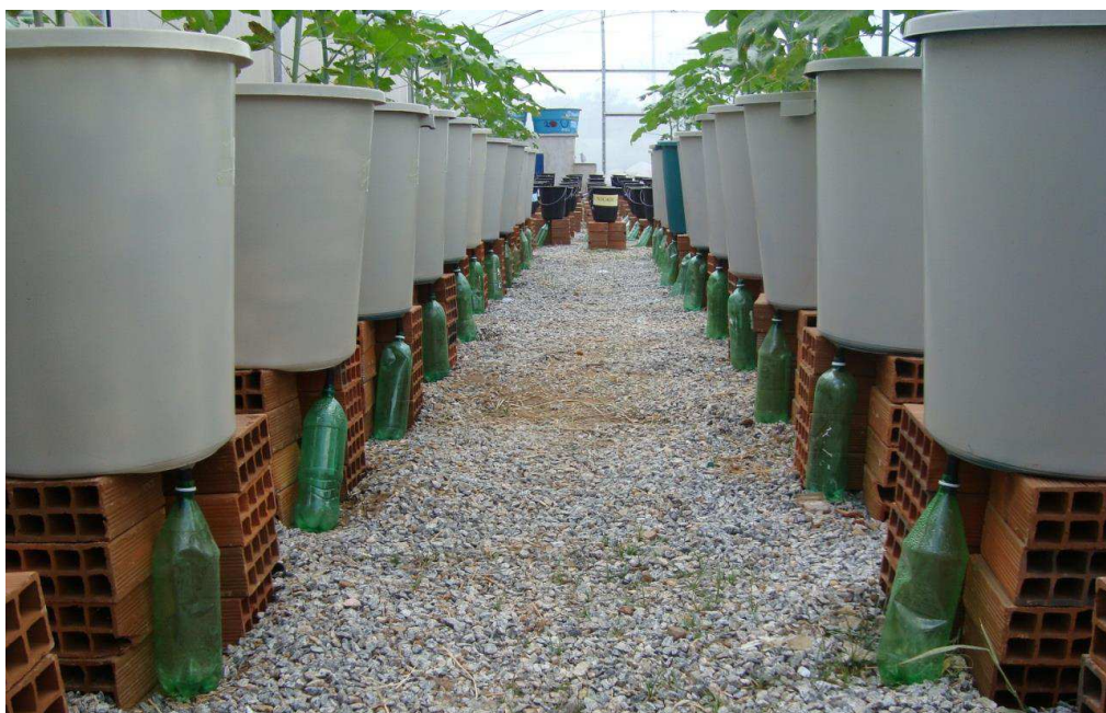
Figura 2. Vista da disposição dos lisímetros e coletores de drenagem
