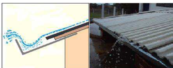
Figura 10 – Teste de desempenho de uma calha em perfil L
