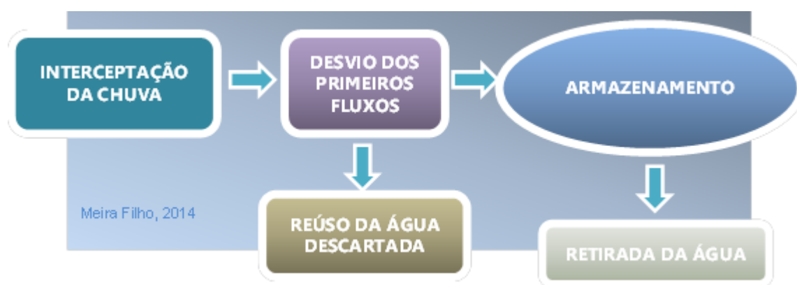
Figura 4 – Fluxograma do processo de captação de água de chuva pelo telhado
