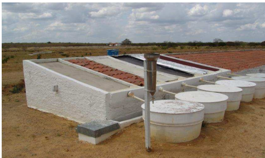
Figura 5 – Experimento da Embrapa Semiárido para determinação de coeficientes de escoamento em diversos materiais de cobertura
