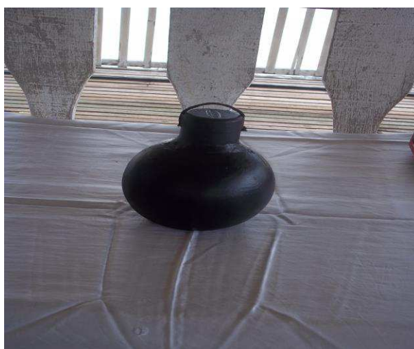
Figura 6. Globo negro com sensor
