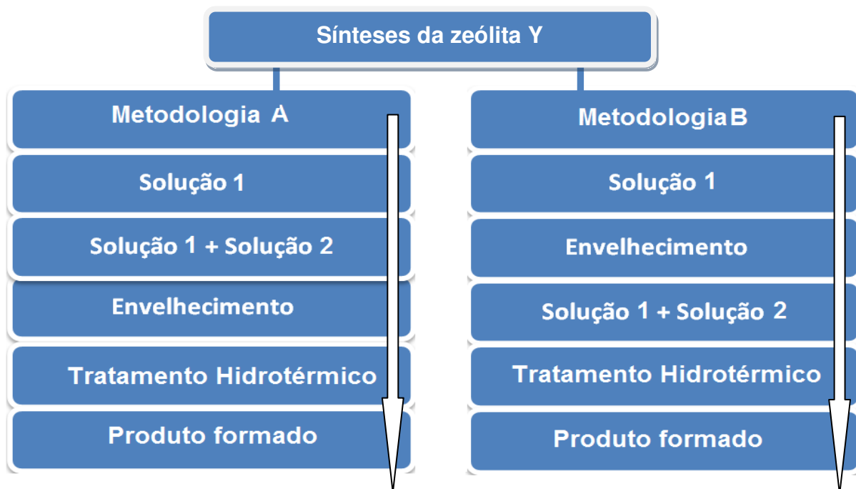
Figura 13. Fluxograma de preparação da zeólita Y a partir das metodologias A e B.
