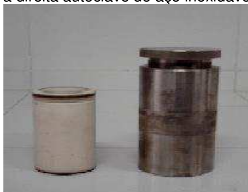
Figura 15. À esquerda cadinho de teflon e a direita autoclave de aço inoxidável
