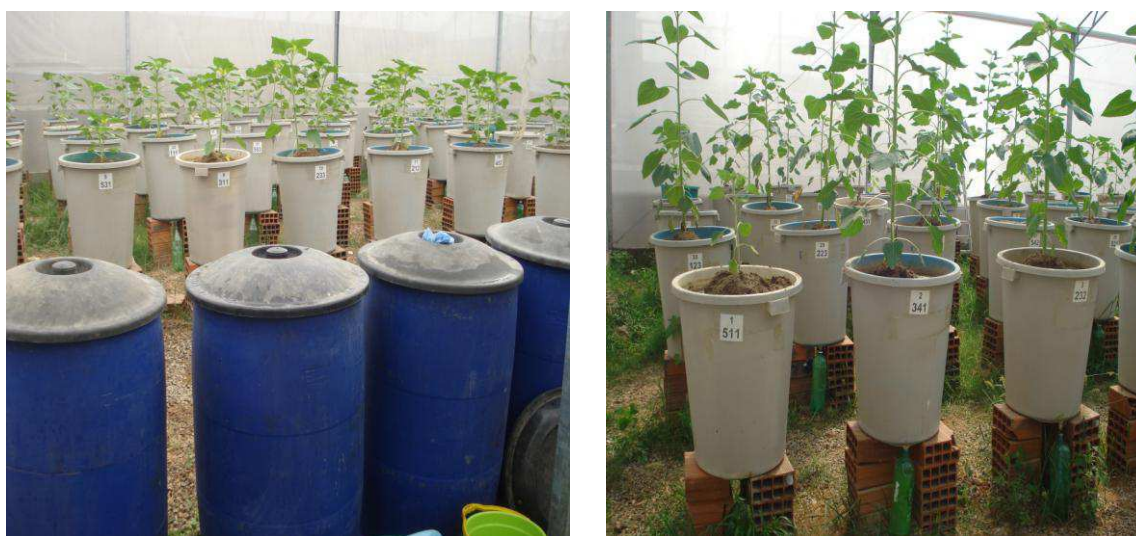
Figura 2.1 Lisímetros de drenagem e recipientes coletores utilizados no experimento.
