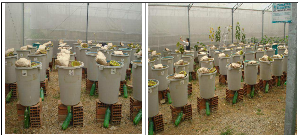
Figura 3.1 Lisímetros de drenagem e recipientes coletores utilizados no experimento.
