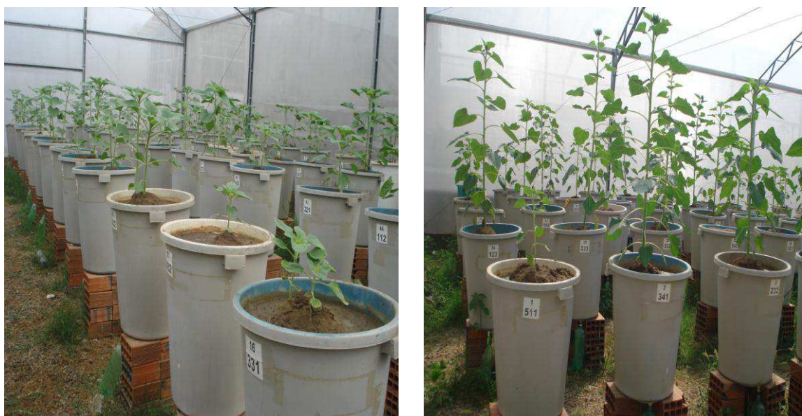
Figura 1.2 Lisímetros de drenagem e recipientes coletores utilizados no experimento.
