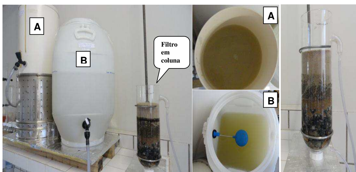
Figura 15 – Montagem do sistema de filtração em coluna de fluxo contínuo.
