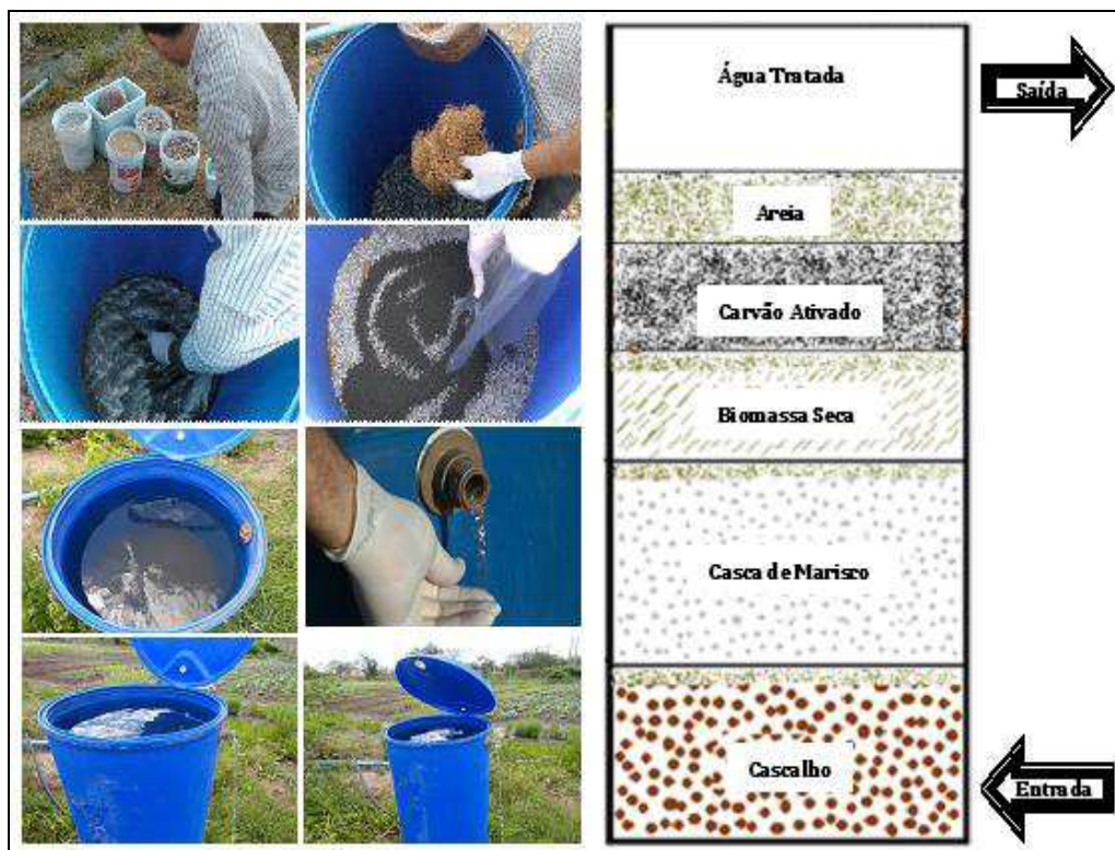
Figura 16 – Modelo de filtro adotado (escala de campo - vazão de 1,2 m 3 /h).
