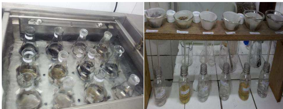
Figura 14 – Procedimento do sistema em batelada para adsorção de nitrato e alumínio.
