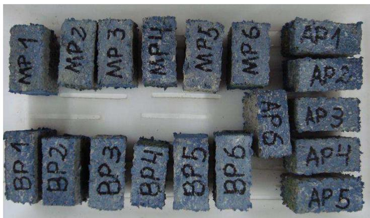
**FIGURA 4.30:** Corpos de prova submetidos ao ensaio de absorção.
