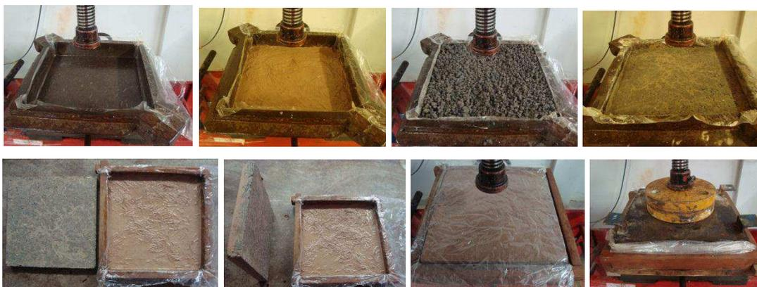
**FIGURA 4.65:** Técnica B de moldagem de estruturas sanduíche – etapas
