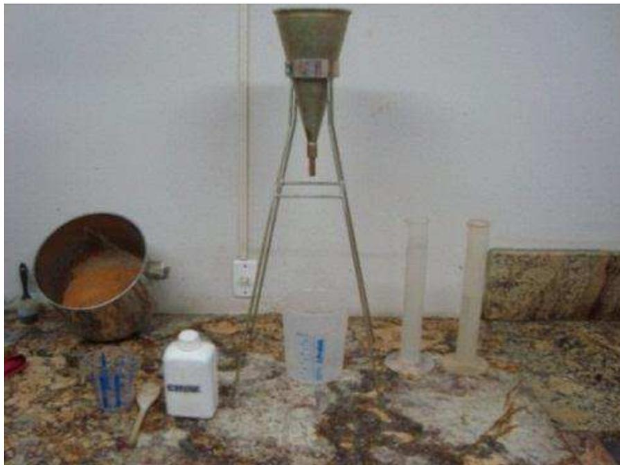
**FIGURA 3.3:** Ensaio do cone de Marsh
