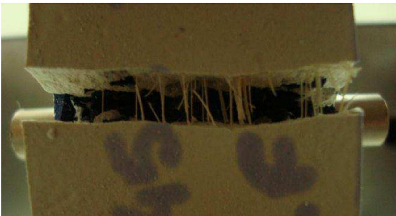
**FIGURA 4.70:** Ensaio de Flexão de compostos gesso:resíduos de SBR revestidos em uma face por outro composto formado por gesso, fator água\gesso de 0,7 e 2% de fibras de sisal.
