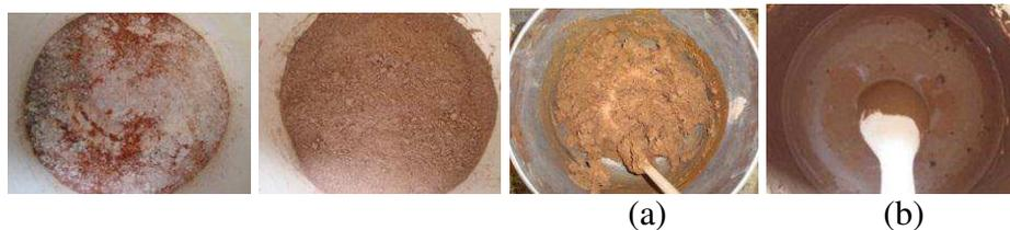
**FIGURA 4.9:** Etapas da mistura de cimento, resíduo cerâmico e metacaulinita, (a) com fator  $a/mc$  de 0,4 (b) com superplastificante.
