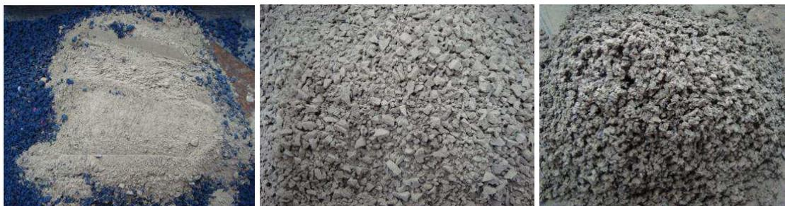
**FIGURA 4.27:** Etapas da mistura para moldagens dos corpos de prova com matriz de cimento e resíduos de SBR de granulometria 345.
