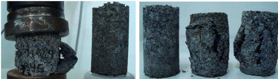
**FIGURA 4.25:** Corpos de prova cilíndricos com traço 1:1:0,4 de cimento e resíduo de SBR com granulometria 345, submetidos ao ensaio de compressão simples.
