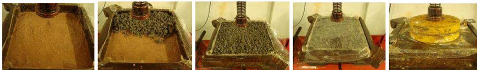
**FIGURA 4.59:** Etapas da moldagem de estruturas, em forma de placas, de compósitos de cimento:resíduos de SBR, revestidos em uma face.
