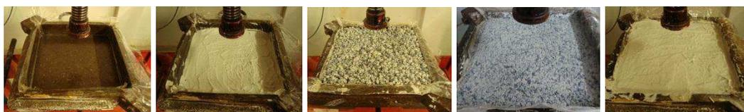
**FIGURA 4.62:** Técnica A de moldagem de estruturas sanduíche - etapas
