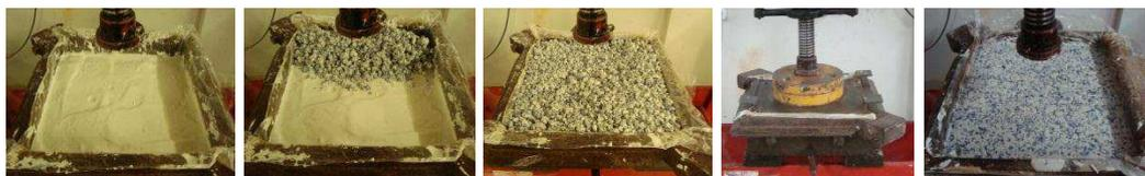
**FIGURA 4.60:** Etapas da moldagem de estruturas, em forma de placas, de compósitos de gesso:resíduos de SBR, revestidos em uma face.
