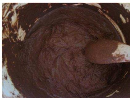
**FIGURA 4.17:** Mistura de cimento, resíduo cerâmico e metacaulinita, com superplastificante, incorporadas fibras de sisal.
