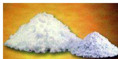
**FIGURA 2.13** : Isolantes térmicos em forma de granulados (BOABAID NETO, 2009).
