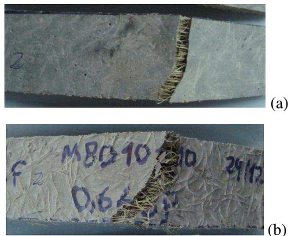
**FIGURA 4.18:** Corpo de prova com matriz de cimento, resíduo cerâmico e metacaulinita, contendo (a) 2% e (b) 3% de fibras de sisal.
