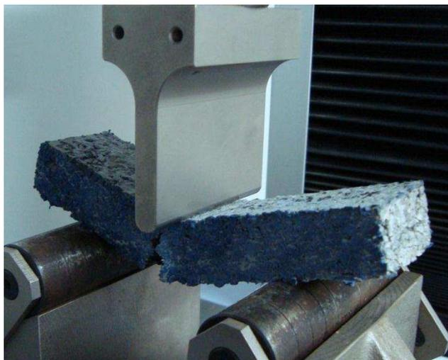
**FIGURA 4.28:** Ensaio de flexão em corpo de prova de matriz de cimento com resíduo de SBR, de granulometria 345.
