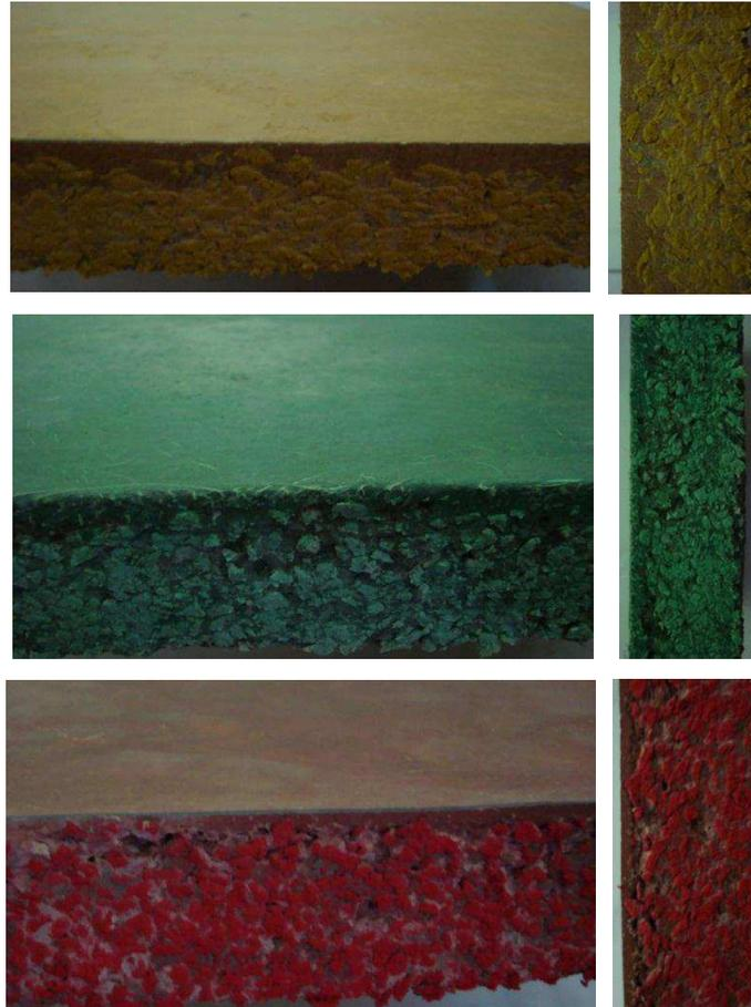
**FIGURA 4.88:** Elementos construtivos coloridos, em forma de placas, desenvolvidos com estruturas revestidas em uma face.
