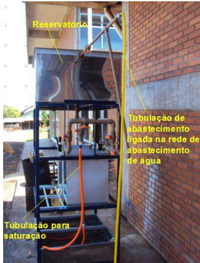
Figura 12 - Tubulações de abastecimento de água do lisímetro
