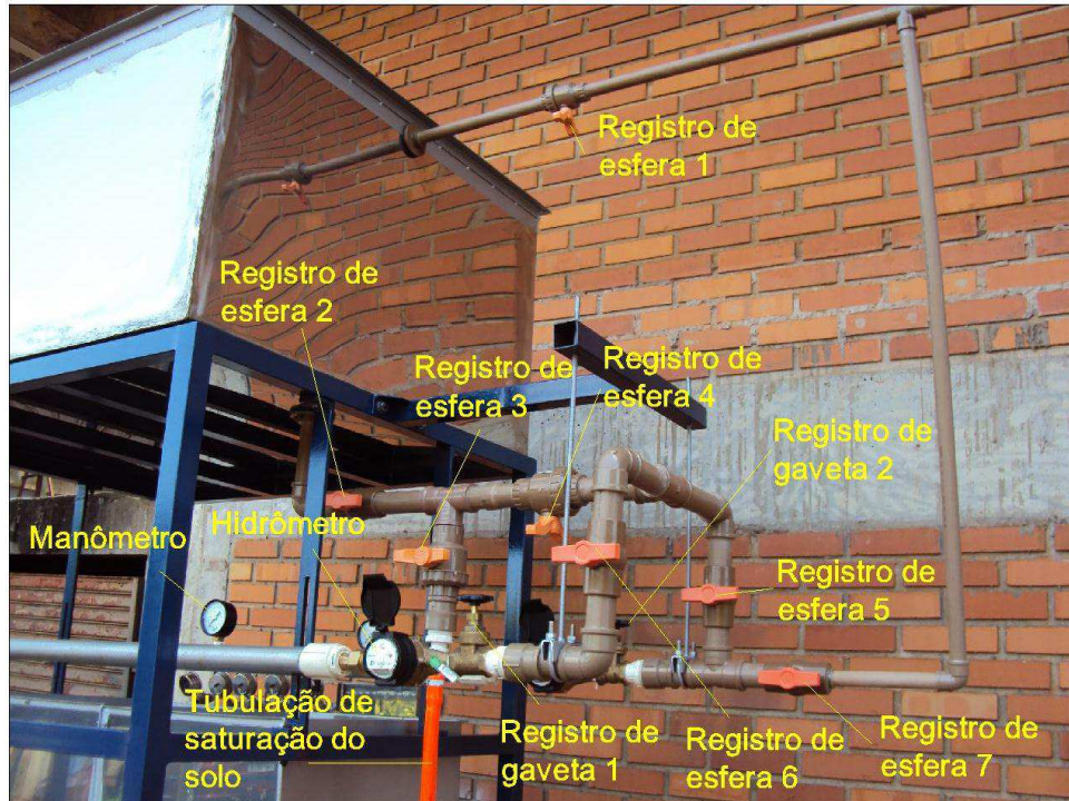
Figura 13 – Registros de esfera e gaveta do lisímetro.
