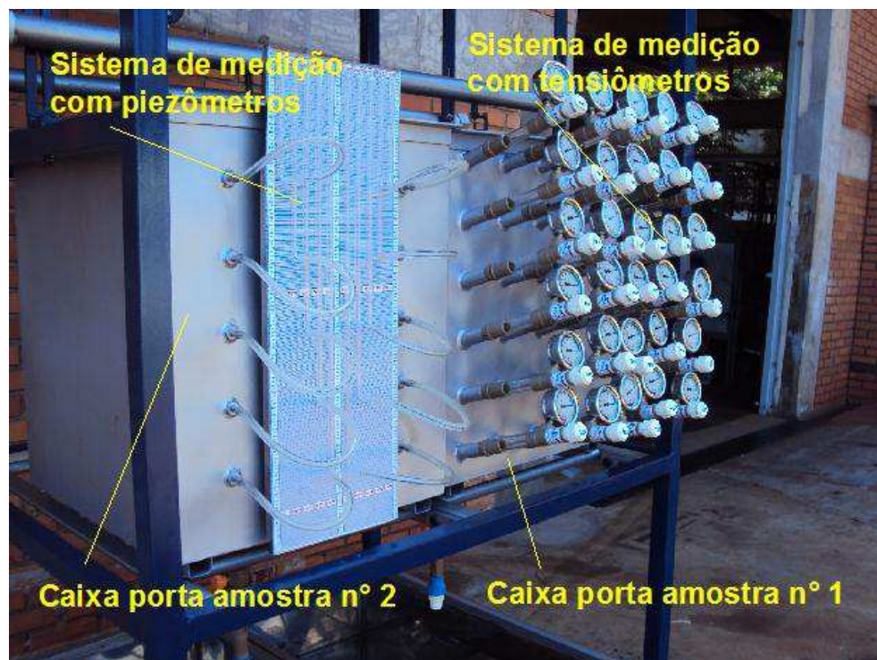
Figura 16 - Sistema de medição com piezômetros e tensiômetros
