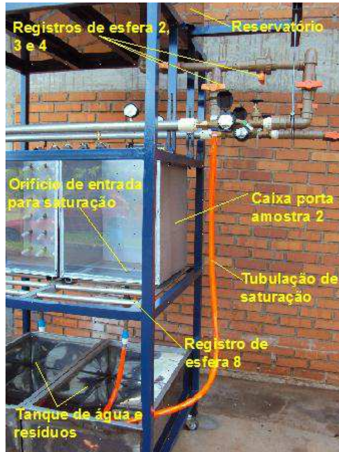
Figura 14 - Tubulação hidráulica de saturação
