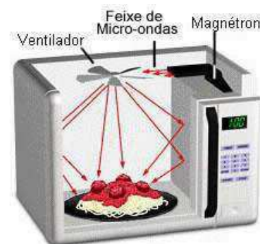
Figura 17: Exemplo do funcionamento de um micro-ondas.
