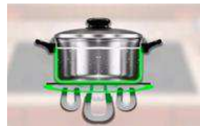
Figura 20: Exemplo do funcionamento de um cooktop com sistema indutivo.
