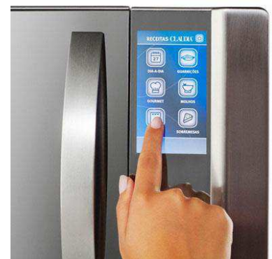
Figura 26: Exemplo da tela resistiva aplicada em um micro-ondas.
