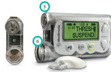
Figura 13: Compartimentos da pilha e reservatório.
