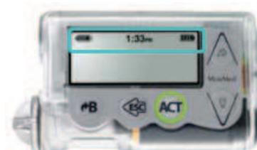
Figura 39: Pilha ou bateria e hora.
