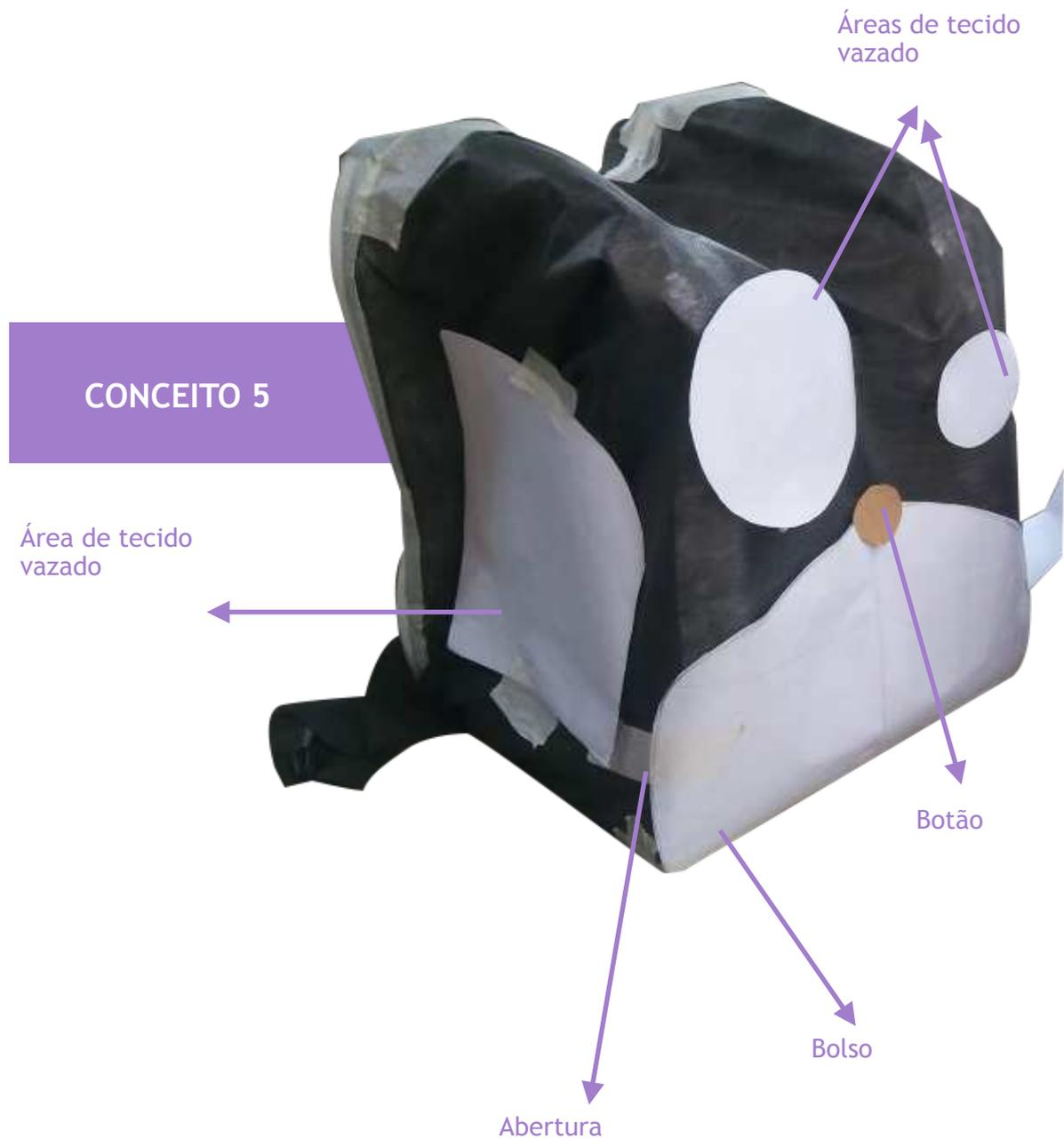
Os mockups possibilitaram a visualização do volume real composto pelos conceitos no todo, e dos elementos existentes, portanto foi possível começar a dimensionar as áreas de tecido vazado presentes na idéia inicial, e também verificar a existência de espaços nas laterais que possibilitavam a existência de mais duas áreas de tecido vazado e conseqüentemente otimizar a função de resfriamento através da circulação do ar.
