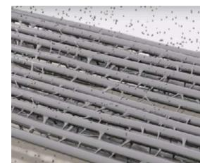
O tecido de nanoPE criado consiste em duas camadas de polietileno modificadas através de tratamentos químicos, com uma malha de algodão no meio, para garantir a estrutura, e considerando suas propriedades, que o tornam eficiente no resfriamento do corpo através da dissipação do calor, é um material adequado para ser utilizado na parte interna do produto, com a finalidade de amenizar o máximo possível o aumento da temperatura corporal do cão.
