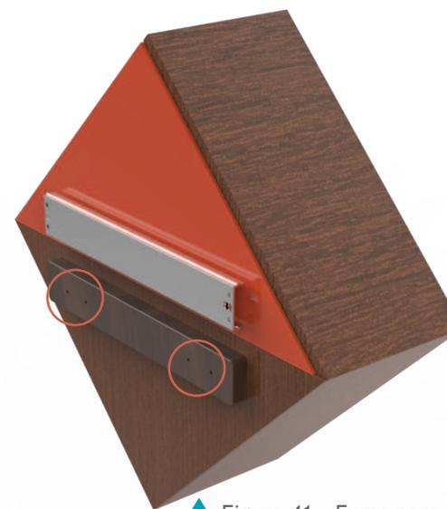
▲ Figura 41 - Furos para fixação na parede
