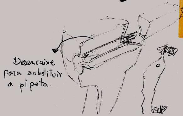
Desencaixe para substituir a pipeta.
